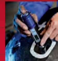
Métodos complexos de fabricação fazem com que uma qualidade assegurada que cubra todas as etapas do processo seja imprescindível. Pela identificação individual de cada peça fundida, a qualidade dos produtos pode ser reproduzida durante todo o processo de produção. Desta forma asseguramos o alto padrão constante de qualidade de nossos produtos. Produzimos de acordo
